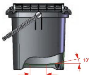
Eimer-Innenboden: mittig in Eimerlängsrichtung verlaufende Schmutzauffangmulde (Breite ca. 6 cm) zur schnellen Reinigung des Wascheimers mit einer handelsüblichen Spachtel
