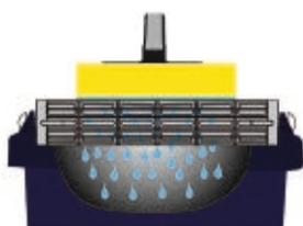
**Die innovative Lamellen-Waschrollen-Systemtechnik:** 1. Gleicher Außendurchmesser auf der gesamten Waschrollenlänge erzielt gleichmäßigen und vollflächigen Anpressdruck der Schwammauflage 2. Konischer Innendurchmesser der Hohlrolle garantiert Wasserdurchlauf zur Eimer-Mitte hin 3. Optimale Aufspreizung der Hydro-Schwammblett-Rastereinschnitte durch innovative Lamellentechnik 4. Wasserüberlaufschutz durch erhöht abgesetzte Abschlussränder
